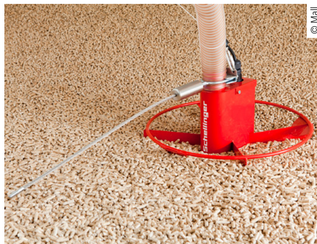
Abb. 7: Der pneumatische Saugroboter »Maulwurf« bewegt sich, vom Heizkessel automatisch gesteuert, über den Holzpelletvorrat
