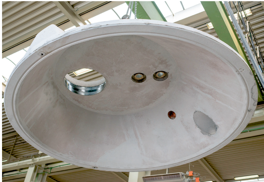
| Bild 5 | Konus eines Pelletspeichers von unten. Links Einstieg, mittig Befüllöffnungen, rechts in der Schräge Durchlass für Leerrohr/Adapterplatte und die vorbereitete Bohrung zum Anschluss einer Lüftungsleitung
